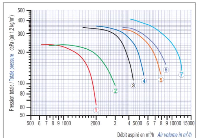
Les courbes indiquent le débit disponible à l'entrée de chaque ventilateur en fonction de la perte de charge qu'il a à vaincre (compter 120 à 150 daPa pour la résistance des poches filtrantes + accessoires éventuels). Les refoulements des ventilateurs N° 5, 6 et 7 doivent être raccordés à une gaine pour réduire la perte de charge au refoulement.
