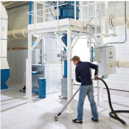
Les **NEUMATIC® JE-JR** sont des dépoussiéreurs à décolmatage automatique par injection d'air comprimé et constituent la pièce maîtresse d'une installation de nettoyage centralisé.
