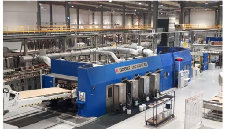
*Système d'aspiration des poussières sur les machines de transformation et d'impression*
